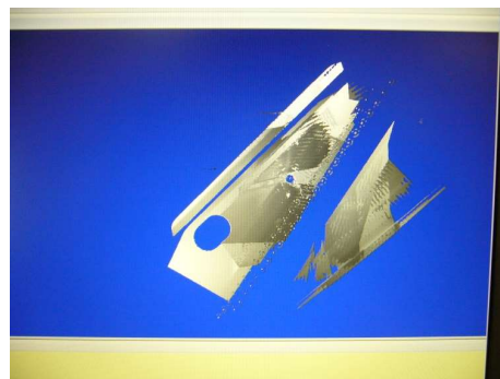
板状部品の3次元形状測定
