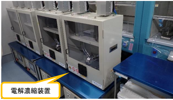
(写真2) 電解濃縮装置の状況
