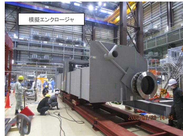
エンクロージャの搬入試験の状況
