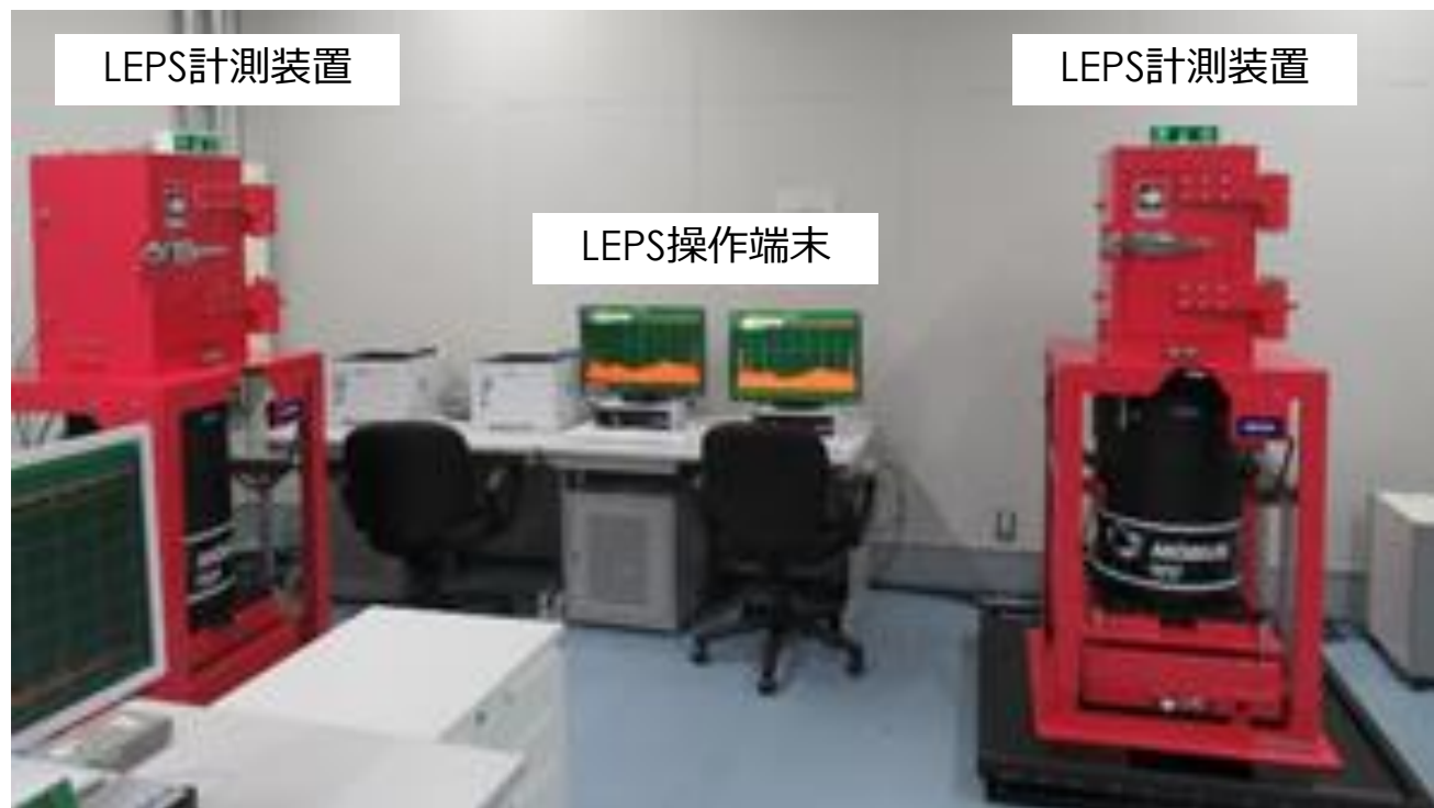
LEPS設置状況 (化学分析棟計測室内)
