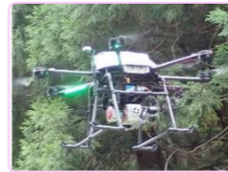
3Dスキャナ搭載ドローンとAIを活用した森林資源利用システム
