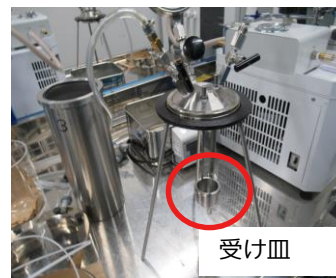
・燃焼装置の受け皿に試料を1回あたり約10gをセット
