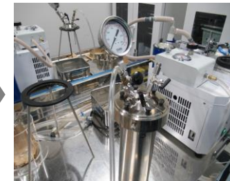
・燃焼装置の下部を取付、密閉 → 燃焼
