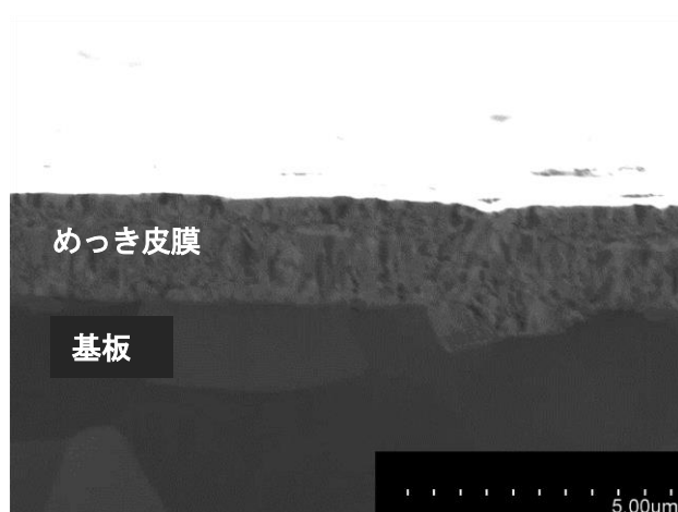
図4 試料AのFIB加工後のSIM観察像
