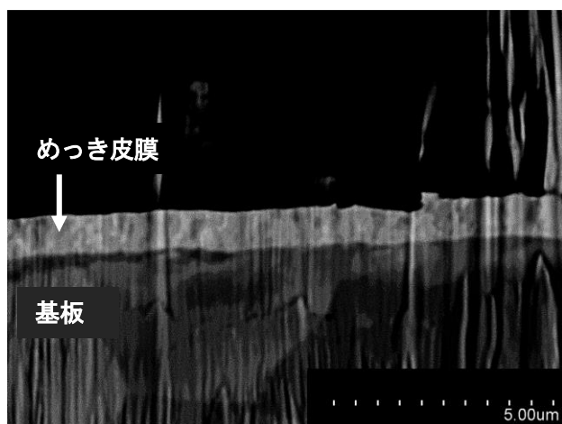
図2 試料AのIM加工後のSEM観察像
