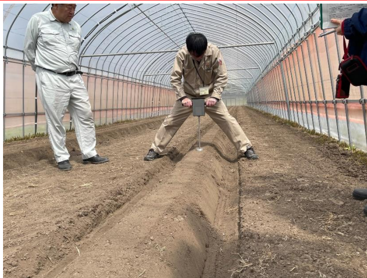
処理前の土壌硬度の測定
