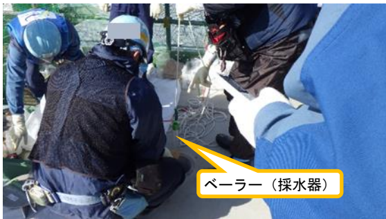
(写真 3 - 1) 放水立坑 (上流水槽) からの試料採 採取の状況①
