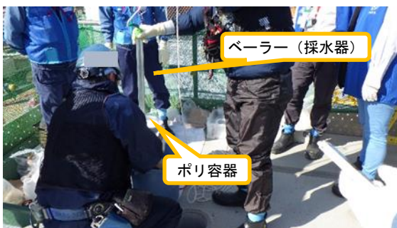
(写真 3 - 2) 放水立坑 (上流水槽) からの試料採 採取の状況②
