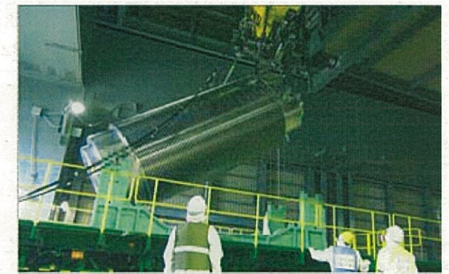
構内輸送容器のトレーラへの積み込み
