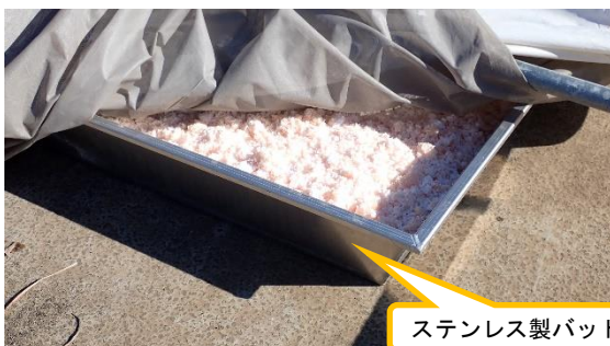
(写真 3 - 2) 燃料油と混合した油吸着凝固剤の状 況
