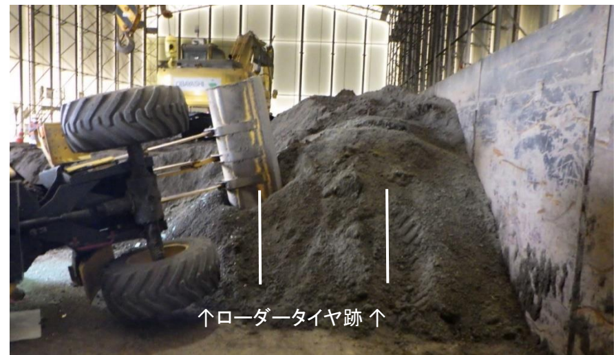
【バックホウと排土山の距離／ホイールローダー横転写真】
