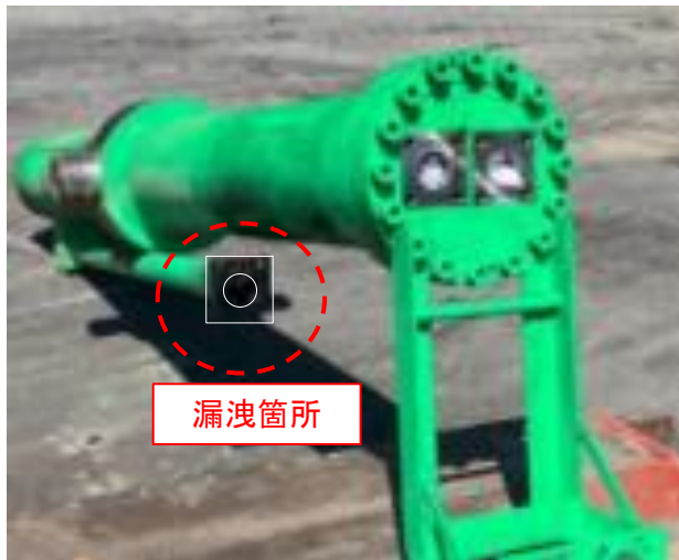
【作動油が漏洩した圧縮梱包機】
