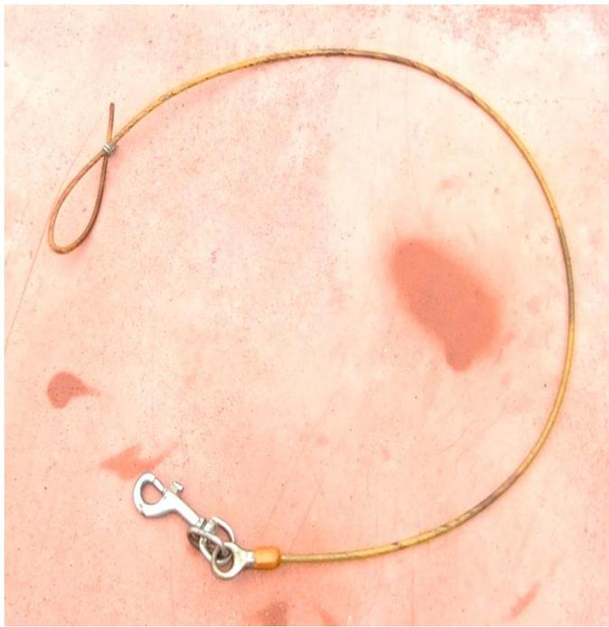
この製品の多くはワイヤーにビニールをコーティングしたものです。地面に擦れてワイヤーに傷がつくと、力が加わった時に容易に断裂します。そのため大型犬や引っ張る力が強い犬のけい留には向きません。また、使用する際は定期的に点検し、少しでも劣化があれば交換する必要があります。
