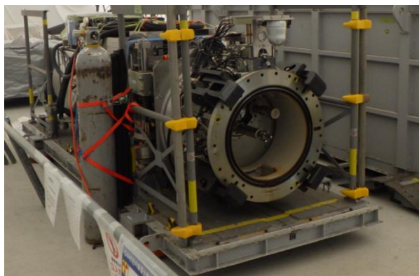
(写真1-2) 堆積物除去装置（高圧水・AWJ）の外観① （装置前面（ペネ接続面）側より撮影）
