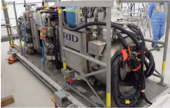
(写真1-3) 堆積物除去装置（高圧水・AWJ）の外観② （装置後面側より撮影）
