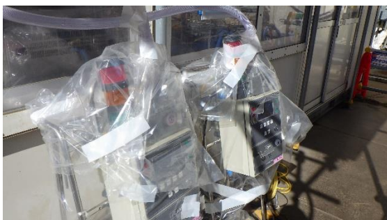
(写真4-2) 同エリア中央部及び南側で連続監視 しているダストモニタ(緑ランプ点 灯)
