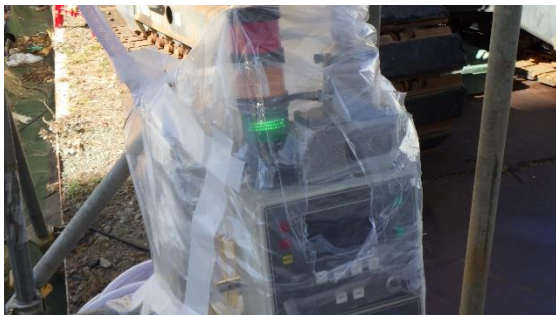
(写真4-1) 作業エリア北部で連続監視している ダストモニタ(緑ランプ点灯：警報設定 値に達していないことを示す)
