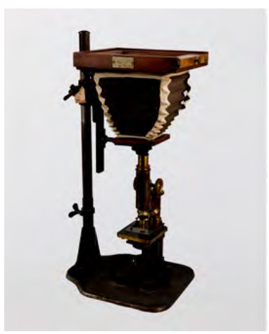
③ 当時のけんびきょう けんびきょうの上のの っているのはカメラです。 英世は、このけんびきょう で病原体の写真をとって いました。
