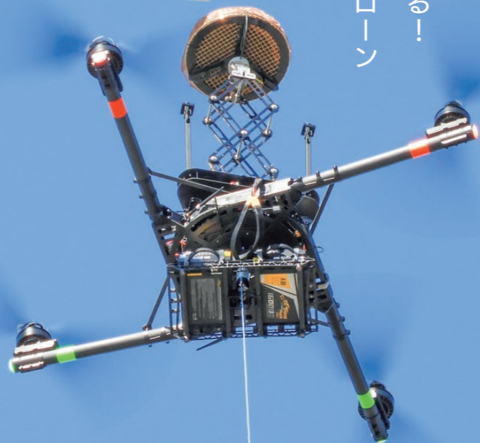
大型風力発電機のブレード先端に備えられている受雷器（レセプタ）にドローン「Dr.Bee」が接触して点検の様子
