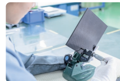
成形されたCFRP素材の検査作業（板厚測定）の様子
