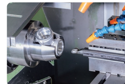
異形状加工物（エルボ状ワーク）の取付け治具（旋盤用チャック）
