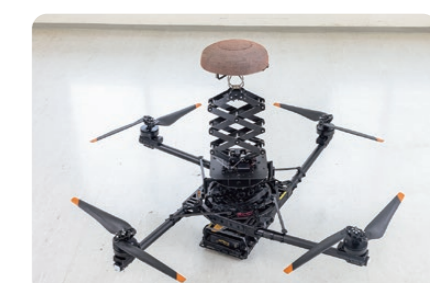
半自律飛行も搭載した、大型風力発電機接地システム点検用ドローンが完成
