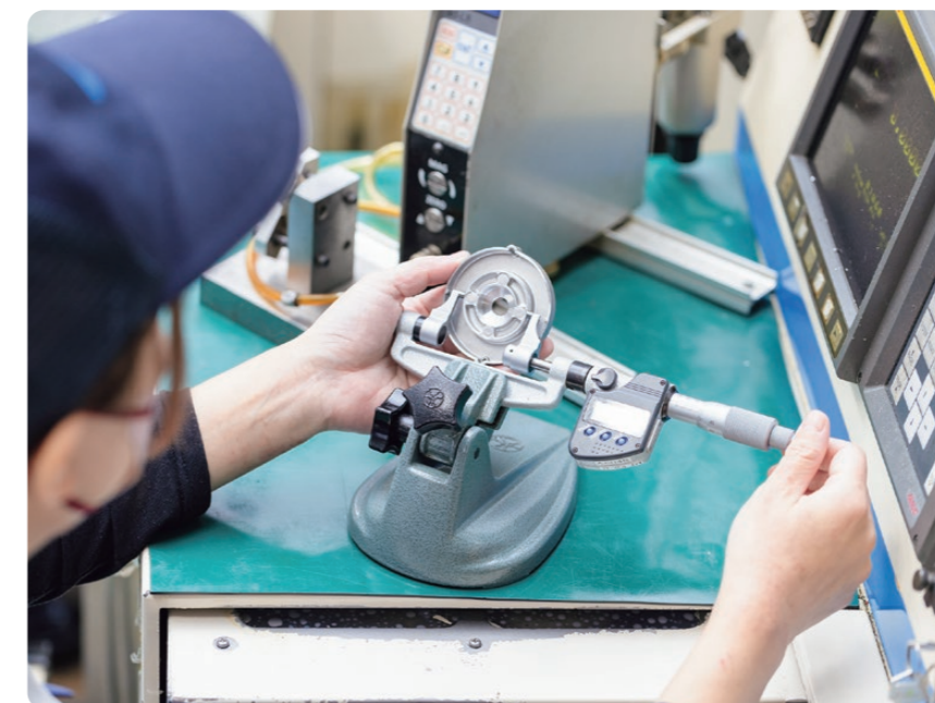
加工時の検査作業の様子（マイクロメーターによる寸法計測）
