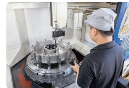
加工物（ワーク）セッティング時の芯出し作業（MC機）の様子
