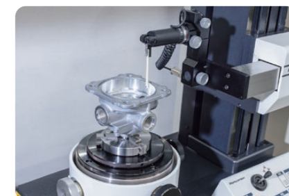
二次加工製品の精度検査（真円度測定）の様子
