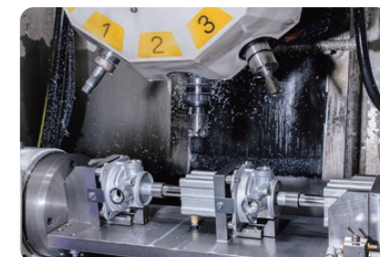
複数個取り仕様の取付け治具（マシニングセンター用）の事例
