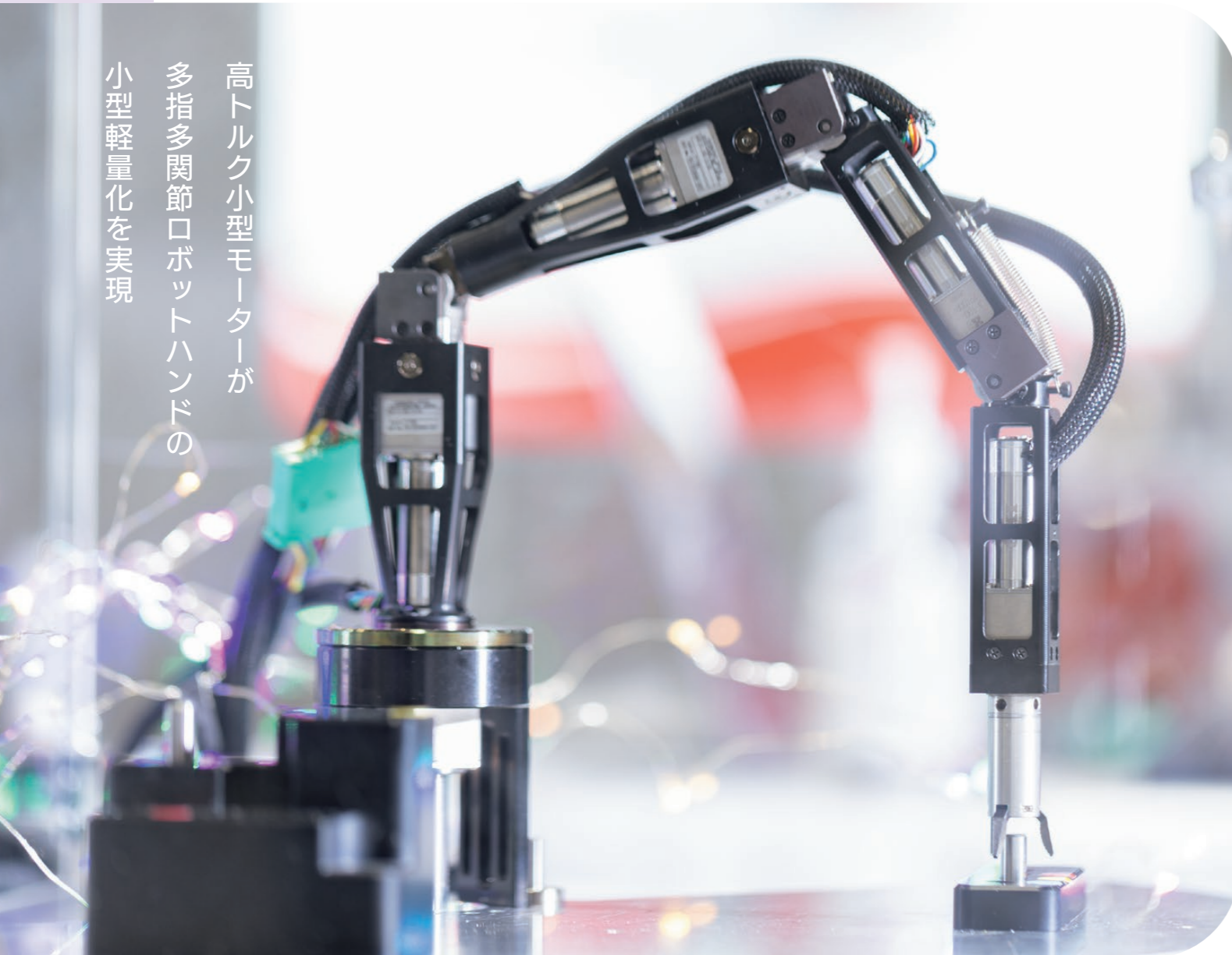
新製品サムベリーナを搭載したアーム長約35cmの小型マニピュレータ
