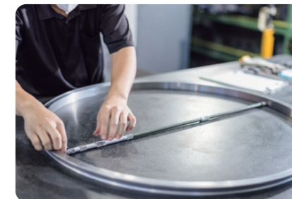
検査作業の様子（ロッド形内側マイクロメーターによる内径計測）
