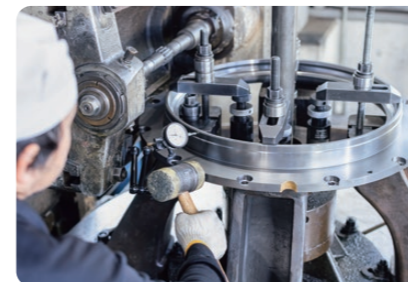
加工物（ワーク）セッティング時の芯出し作業（ホブ盤）の様子
