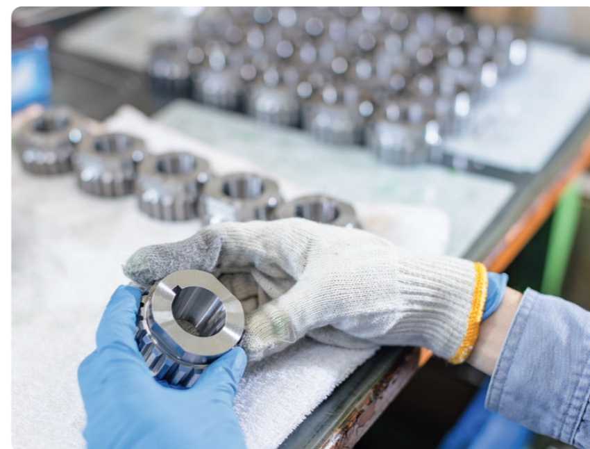
歯車製品の外觀検査の様子（製品の向こうにユーザーが存在することを意識して一点一点入念な検査が行われる）
