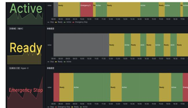
図4 加工機稼働監視IoTシステムダッシュボード
