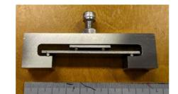
板状試験片に曲げ変形を 与えた状態で治具ごと浸漬
