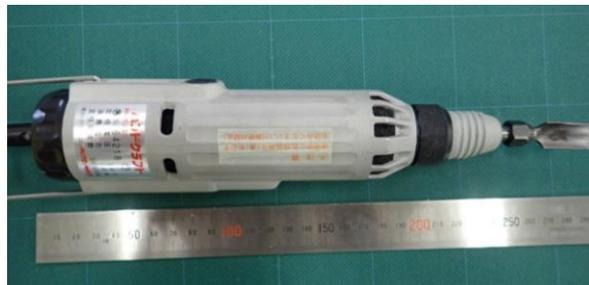
図2 使用した超振動工具
