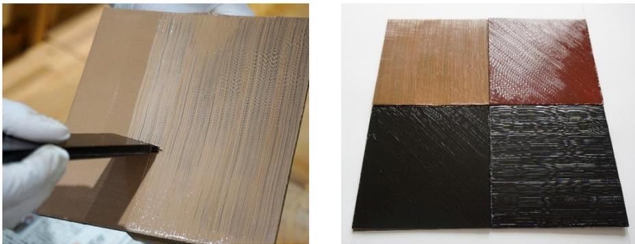
図3 水を添加した漆を用いた刷毛目塗のパネル
