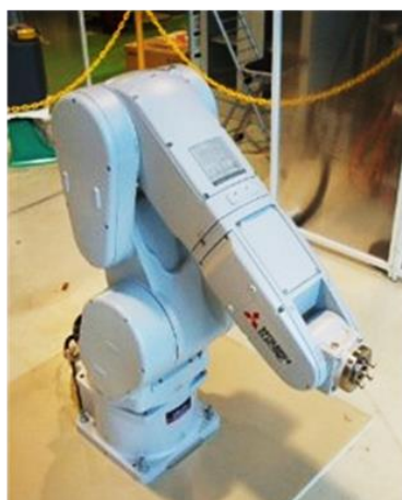
6軸垂直多関節ロボットRV-20F-D (三菱電機 (株))
