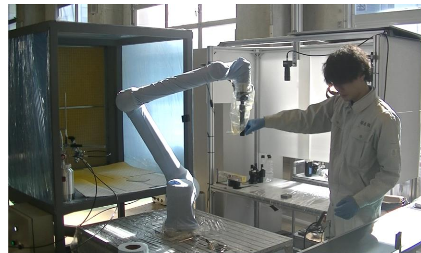
塗装したワークを作業者へ渡す
