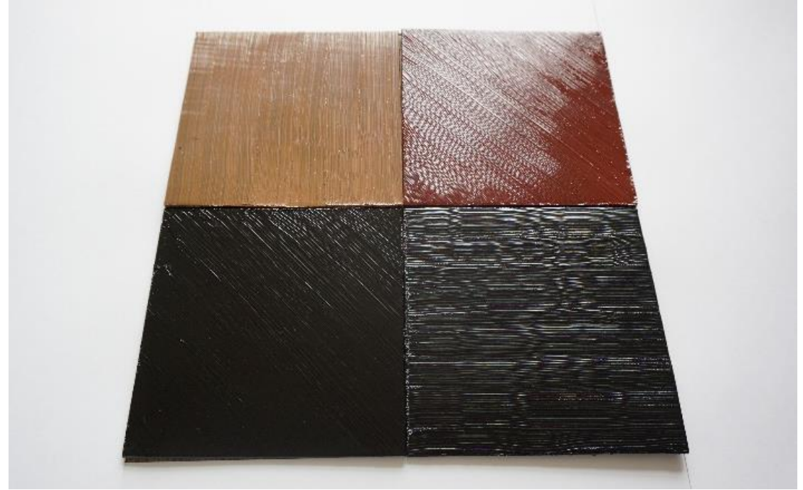
完成した刷毛目塗のパネル
