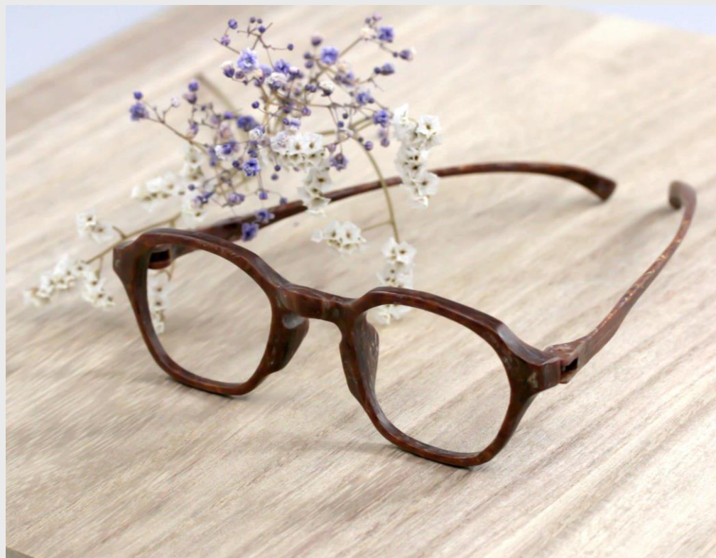
木材（サワグルミ）+フェノール樹脂複合材 主な切削条件 刃数 2 φ3[mm]超鋼ボールエンドミル、回転数 10,000[rpm]、 送り速度 455[mm/min]、切り込み量 0.1[mm]、切削パス間隔 0.1[mm]
