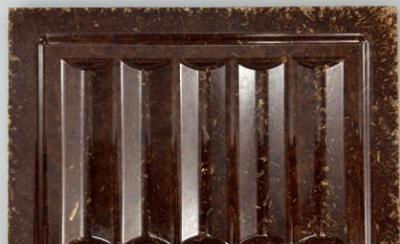
木材（サワグルミ）+フェノール樹脂複合材 成形温度 135℃ 成形力 480kN/200×150 mm当たり
