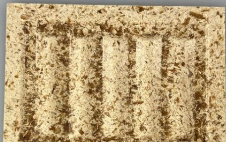
木材（サワグルミ）+メラミン樹脂複合材 成形温度 135℃ 成形力 480kN/200×150 mm当たり
