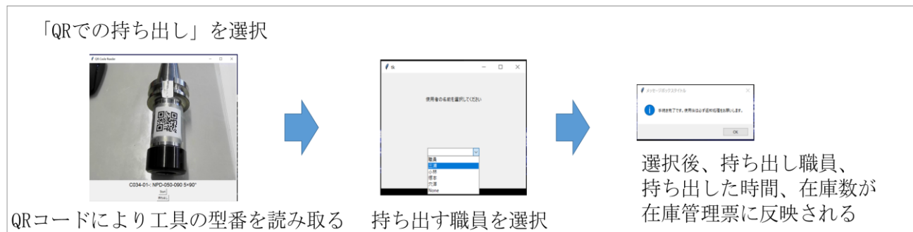
図3 QRコードによる持ち出し処理の流れ
