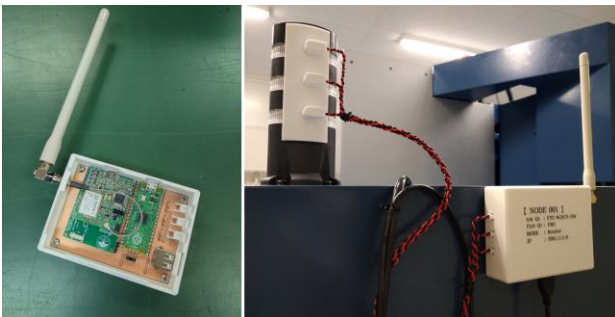
図 9 実験用 IoT デバイス外観と加工機積層灯への取付け
