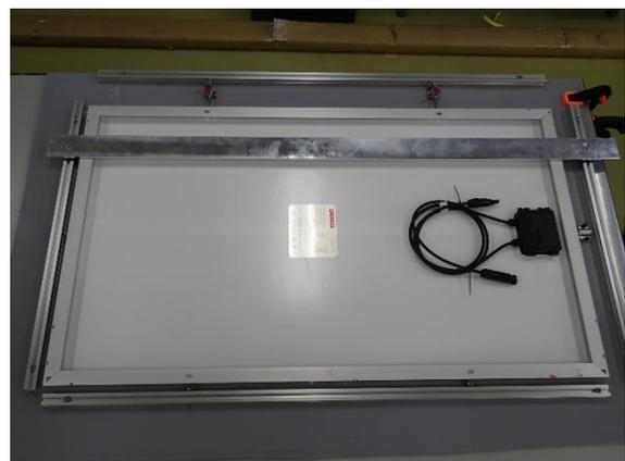
図9 作製したパネル固定治具
