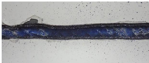
図5 ガラスの割れた破損パネルからの銅配線回収部
