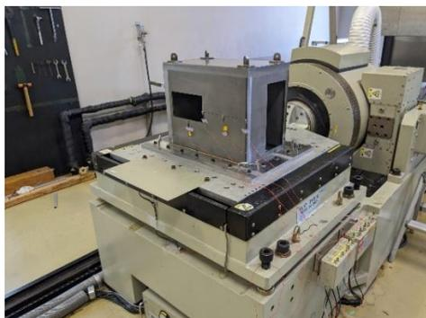
図4 振動試験の状況
