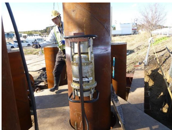
検査対象の杭とX線発生装置の取り付け状況
