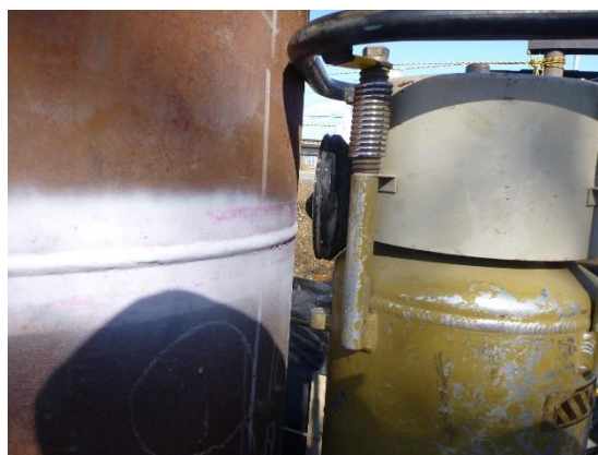
検査対象の杭とX線発生装置の取り付け状況
