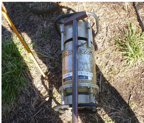
写真 X線発生装置の使用状況（3月29日）
