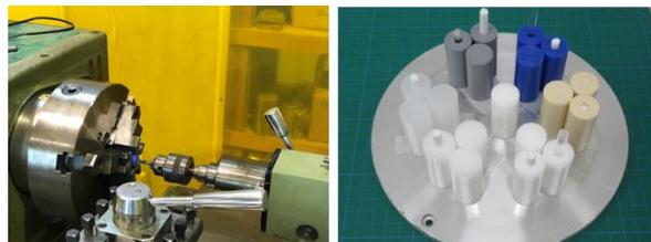
図 2 コントラスト分解能評価試料
