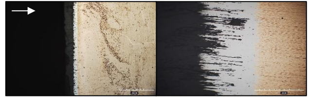
図 9 湿式研磨による斜め研磨後の試験片 矢印は研磨盤の回転方向
