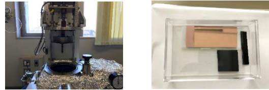
図1 試験片の作製 (左: RFスパッタ装置 右: 作製した試験片)
