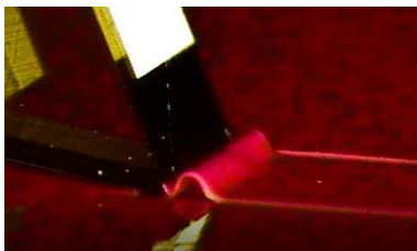
図6 接着性の悪い塗膜の剥離の様子
