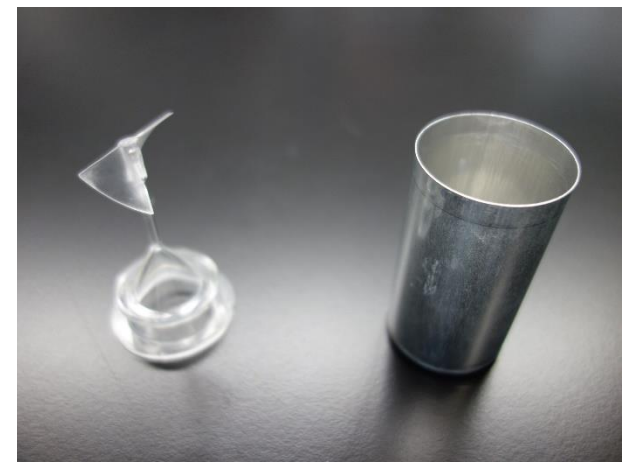
缶（左）に試料を入れ、パドル（右）をセットし測定
