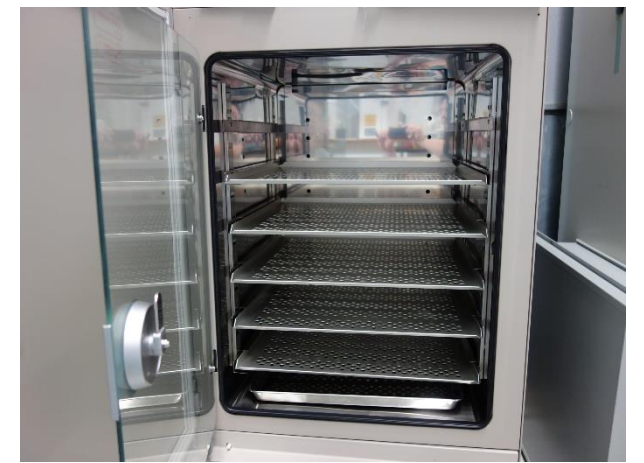
庫内 約167L 下部に水を入れた加温バットを 設置して湿度を維持
