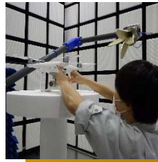
ドローンの無線性能評価の様子
