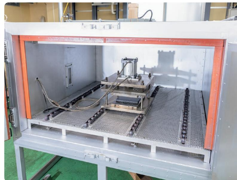
オートクレーブに代わり、熱プレス成形の応用【成形炉（加熱炉）内にセットした高圧プレス&金型でプリプレグを加熱・加圧】でCFRP素材の成形を実現している
