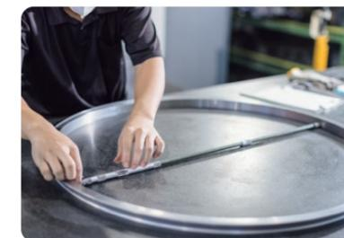
検査作業の様子（ロッド形内側マイクロメーターによる内径計測）
