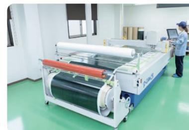
CFRPプリプレグ（炭素繊維中間材料）を裁断するCNC裁断機
