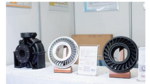
従来からアルミ鋳造の一貫生産をしていました。現在は、その技術を利用してプラスチックの成形にも取り組んでいます。プラスチックを使用することで軽量化を図ることができます。プラスチック成形の技術を活かし、ロボット分野に参入したいと考えています。
