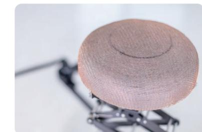
測定ユニットは受雷器（レセプタ）接触時に当たりやすくなるための構造及び、どの角度で接触してもドローンの姿勢を崩しにくい工夫を施している
