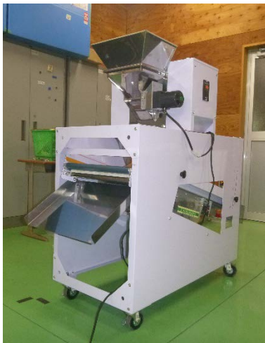
写真1 エゴマ選別機試作機
