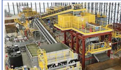
除去土壌を写真の機械で粒径別にふるい分けすることにより、放射能濃度の高いシルトや粘土と濃度の低い礫や砂に分離する技術。
