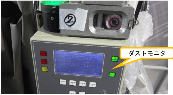
(写真 2 - 2) ダストモニタの設置状況 ※ダストモニタは、2台で測定を実施。
