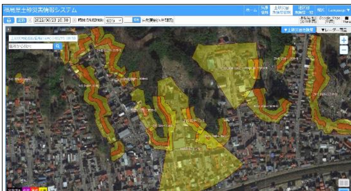
従来の土砂災害情報システム （土砂災害警戒区域のみの表示）
