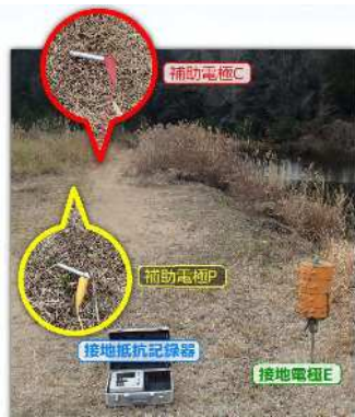
③接地電極などの配置
