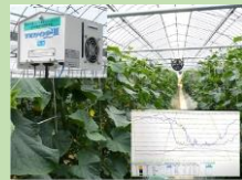
園芸施設の環境測定装置
