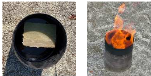
図5 ロックウールを芯材とした例
