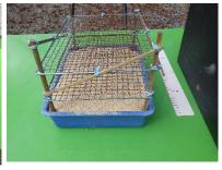
図-4 倒伏防止用金属網
