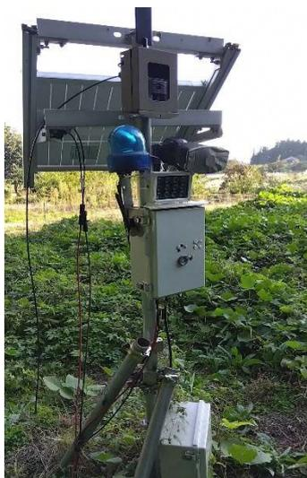
図 13 警報装置の設置例
