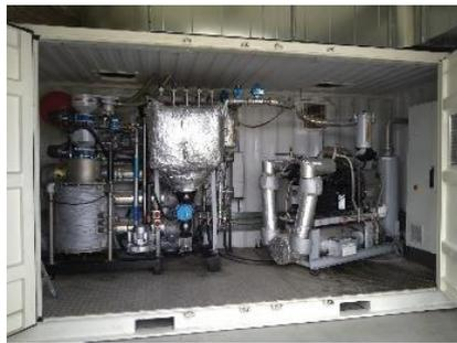
木質ペレットガス化熱電併給装置（提供：(株) シーズ）
