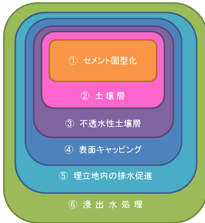
図 2-2 放射性物質の漏出に対する多重防護の概念図
