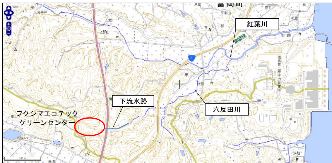
図 1-12 処理水の放流経路
