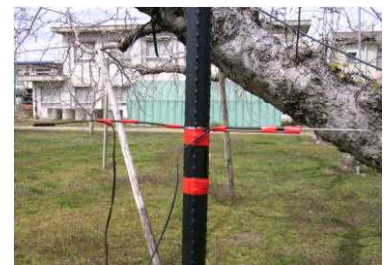
図2 温度センサーの設置方法
