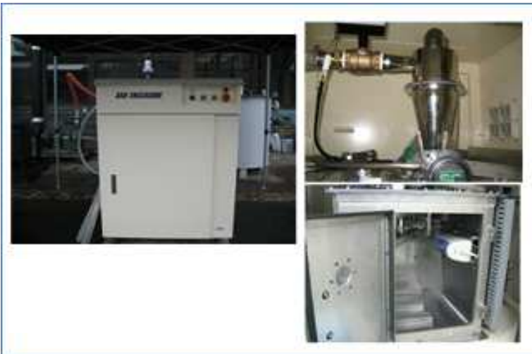
写真－燃焼灰回収装置
