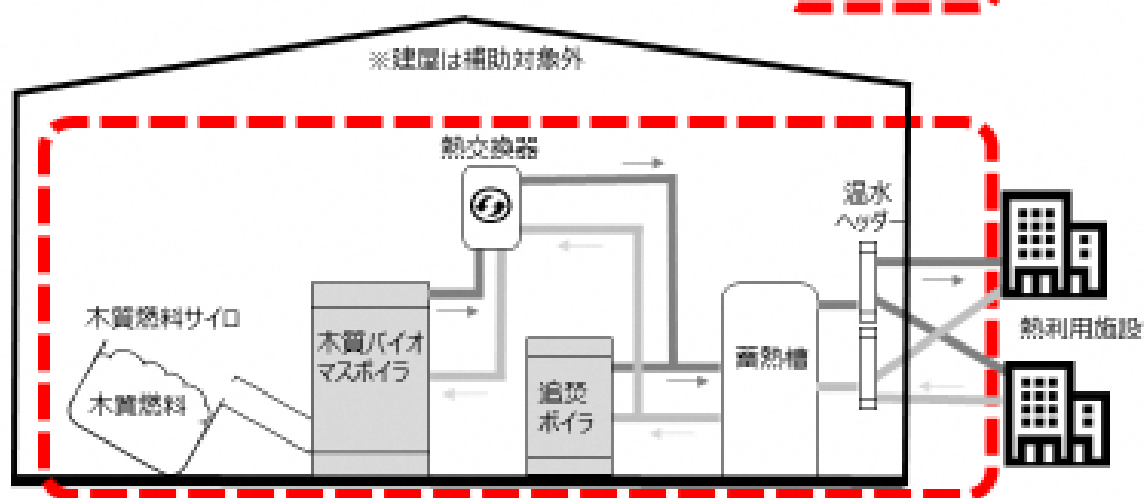
バイオマス熱利用設備の例 木質バイオマス熱利用設備 + バイオマス燃料製造設備
