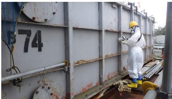
(写真 4) ノッチタンク表面線量率の測定 状況
